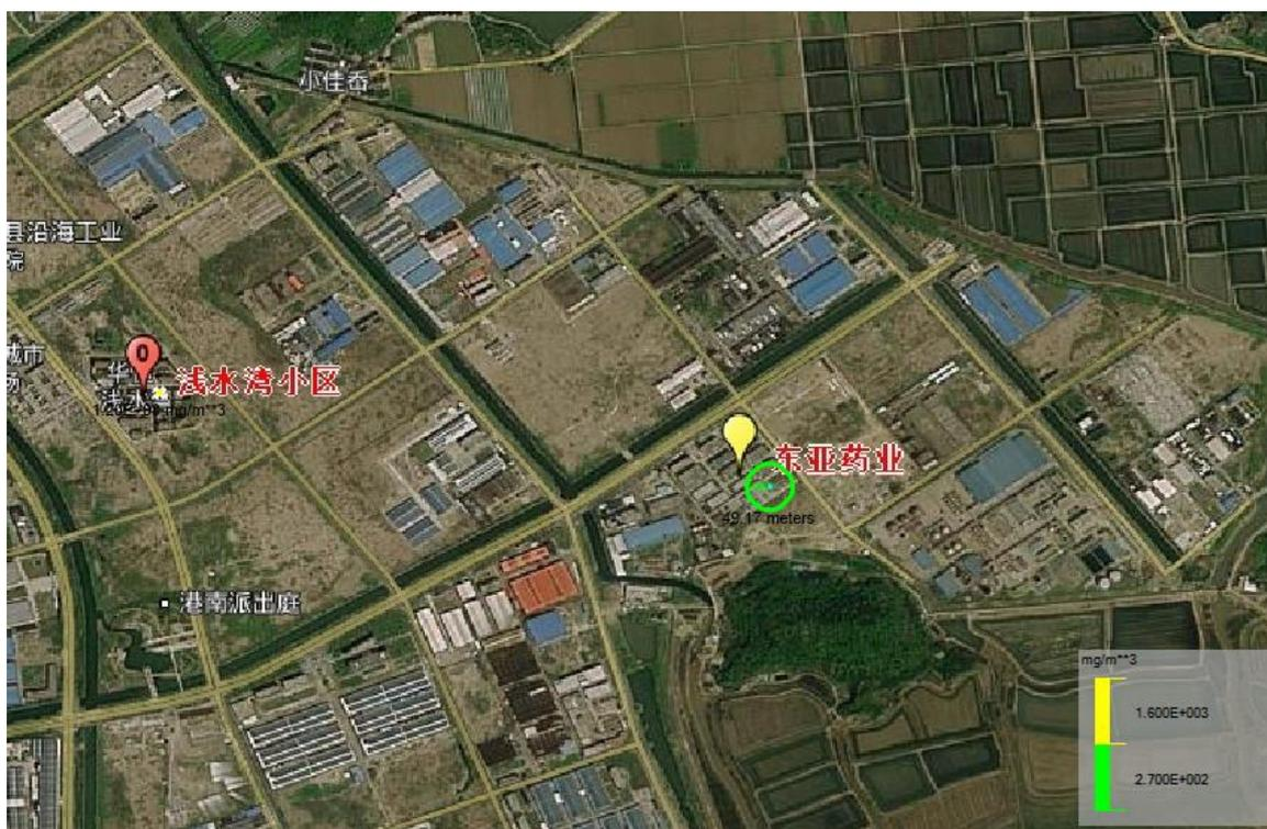
图 6.3.5-3 DMF 储罐泄漏影响预测图
